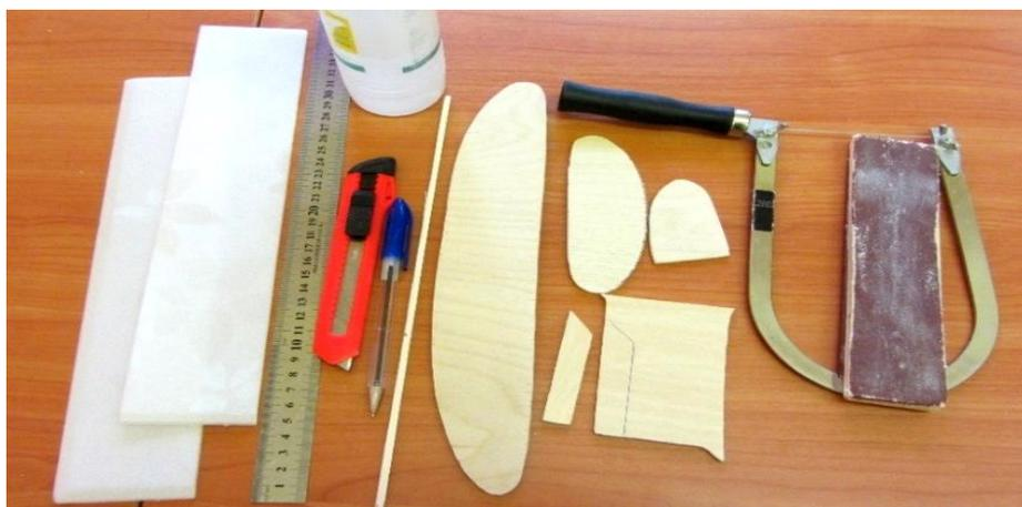
1. Выкладываем шаблоны крыла, стабилизатора и киля на листе пенопласта, обводим их ручкой. Вырезаем заготовки согласно чертежу.
