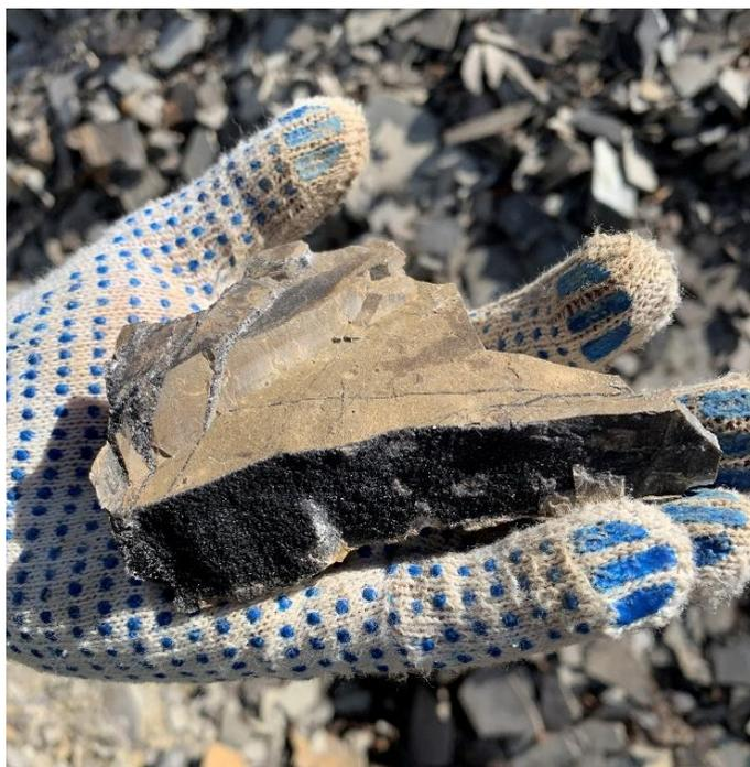
Рис. 1. Известково-глинистый сланец с выделением битумов по трещинам
